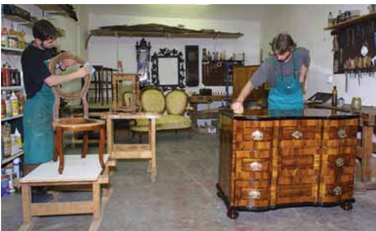
Nanášení šelakové politury a broušení starého laku
