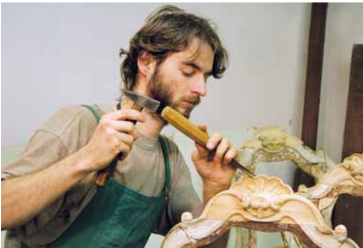
Doplňování chybějící řezby
